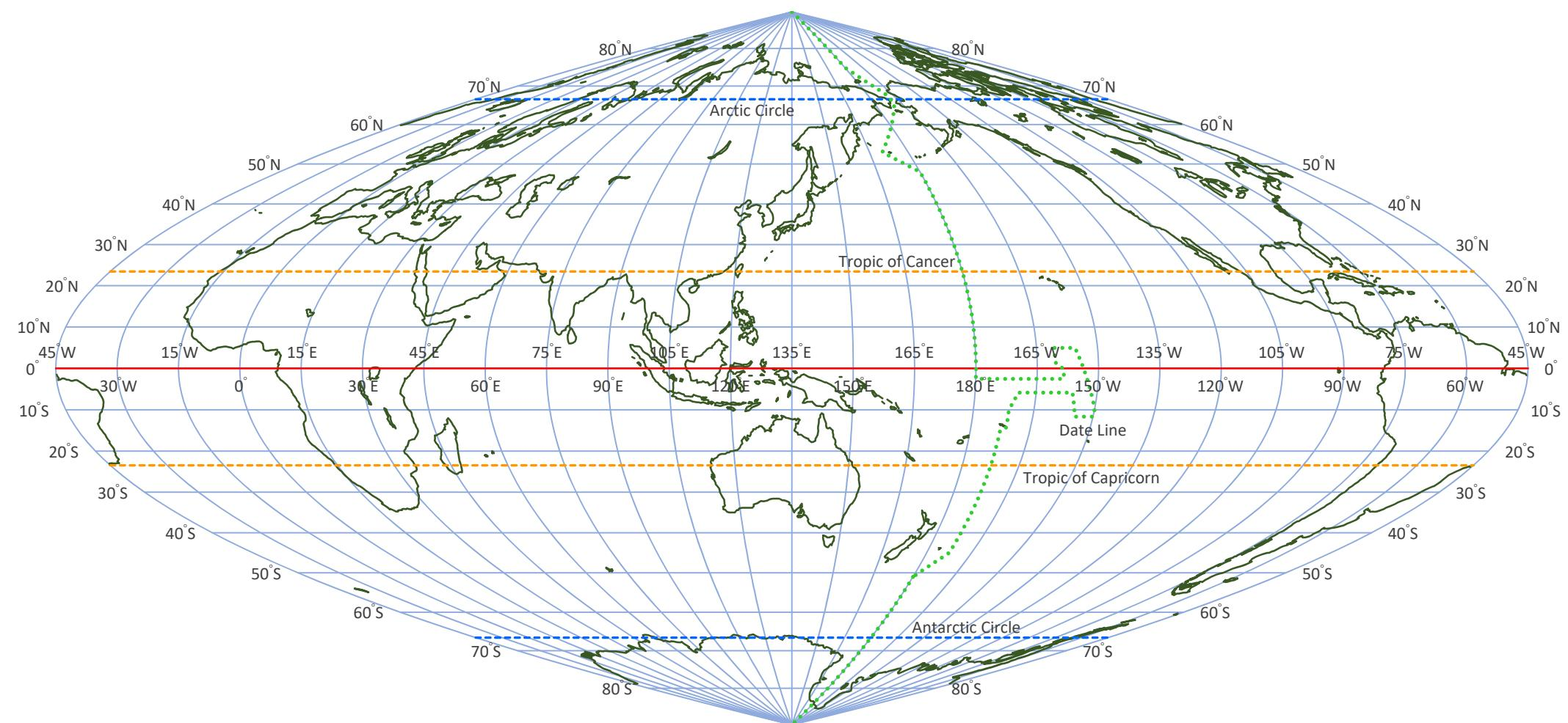
[図 6-2-1-3] クラスター放物線図法（Craster Parabolic Projection）【地図主点(中心)】東経 135°、緯度 0° 【経度間隔】15° 【緯度間隔】10°
